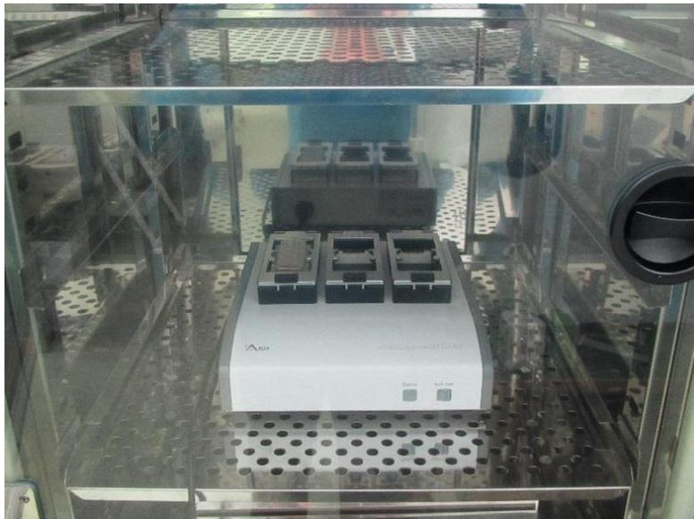
図 3 リアルタイム細胞アナライザー (インキュベータ内設置)
