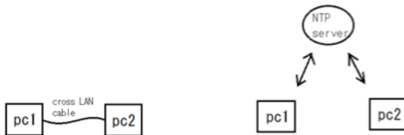
Figure 1 PC の時刻同期方式、左：クロス LAN ケーブルによる方法、右：NTP サーバ参照による方法
