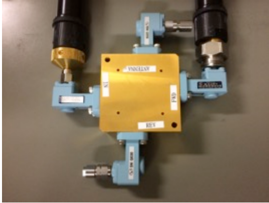
Figure 3 方向性結合器の s パラメータ測定の様子
