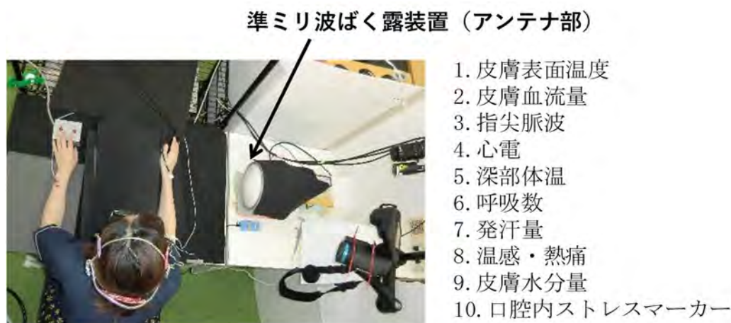
図 3.1 人体を対象とした準ミリ波・ミリ波局所ばく露実験
